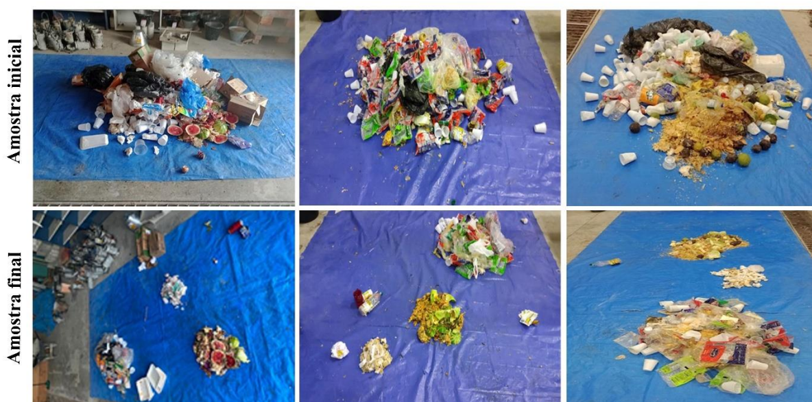
Figura 3 – Amostras das coletas no RU ante e após o processo de quarteamento.
