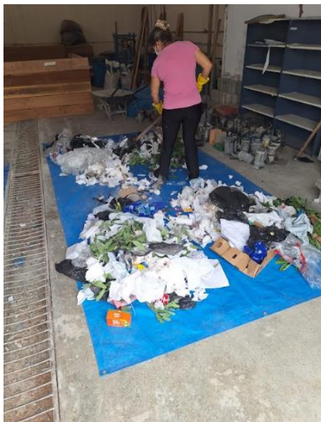
Figura 209 – Processo de separação para quarteamento
