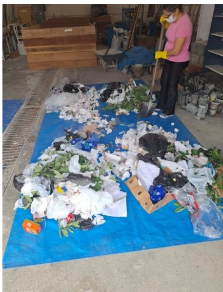
Figura 206 – Processo de preparação para quarteamento
