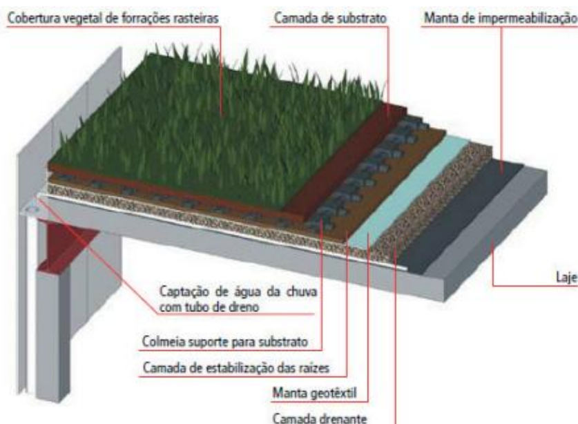
Figura 12 - Estrutura do telhado verde.
