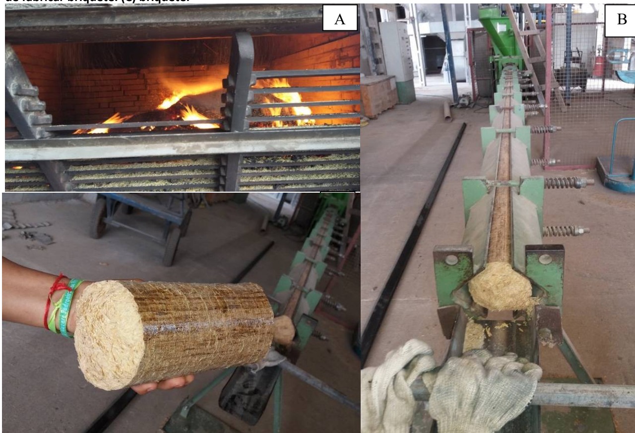
Figura 2. Utilização das cascas pelas beneficiadoras locais. (A) cascas utilizadas in natura nas fornalhas. (B) máquina de fabricar briquete. (C) briquete.
