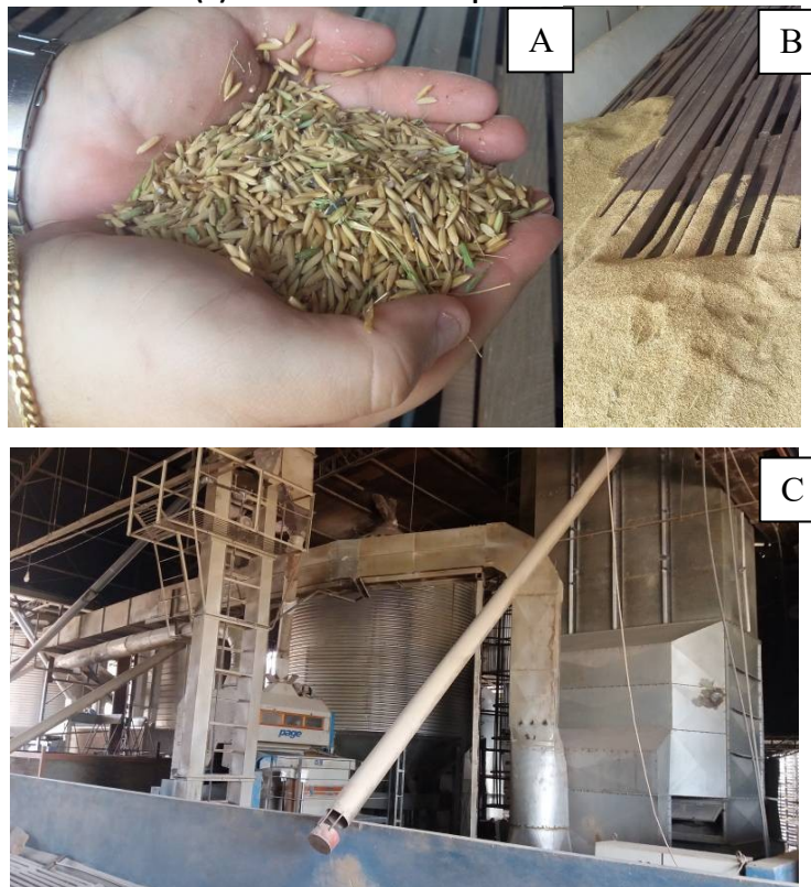
Figura 1. Início do beneficiamento do arroz. (A) arroz recém chegado à beneficiadora. (B) entrada do arroz no sistema de beneficiamento. (C) Fornos e Silos de espera.
