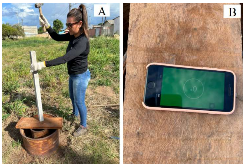
Figura 40 - Processo de cravação e nivelamento dos cilindros
