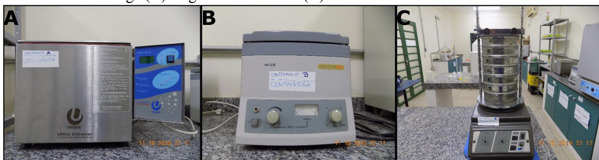
Figura 6 - Equipamentos utilizados na análise granulométrica: lavadora ultrassônica (A), centrífuga (B) e agitador mecânico (C)
