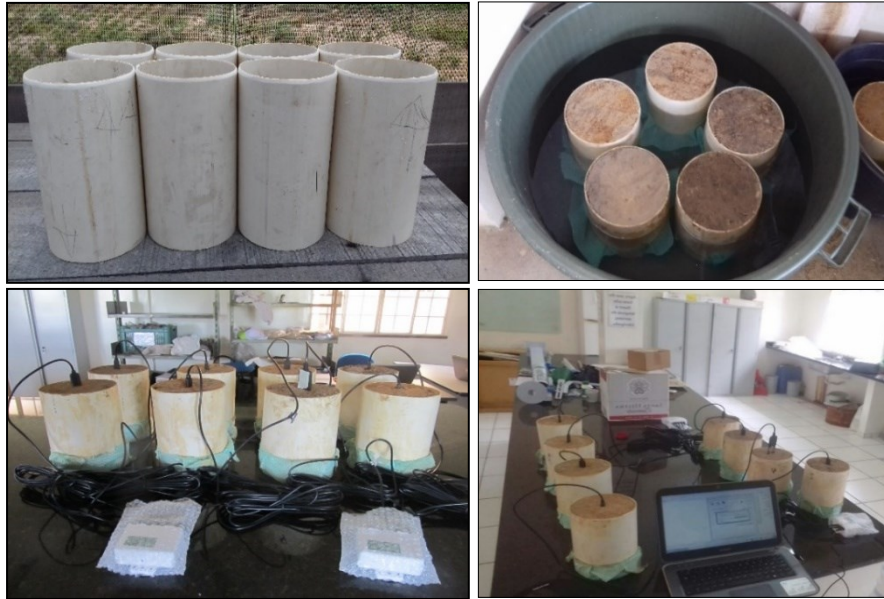
Figura 1. Colecta, saturación y colocación de los sensores 10HS ® en las muestras de suelo.
