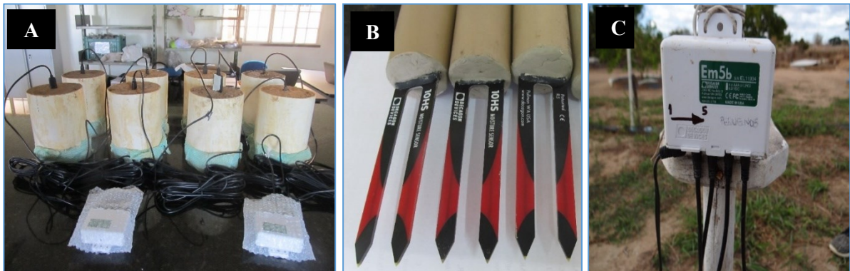
Figura 3. Detalhes da Calibração (A) e acondicionamento dos sensores (B), e Data logger-Em5b® (C) para o registro dos dados de umidade volumétrica no solo.
