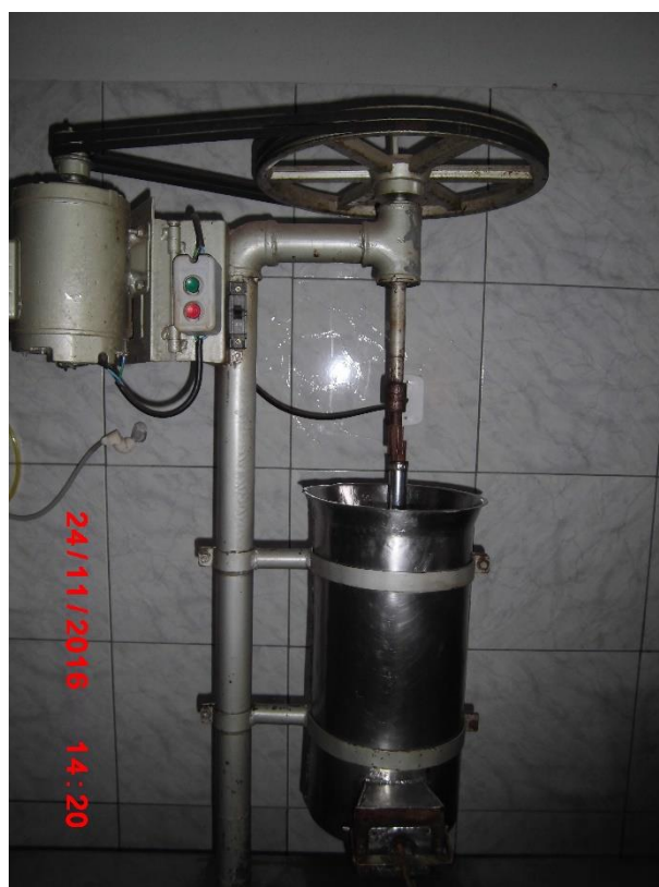
Figura 34 – Despolpadeira utilizada pela empresa J. G. Ribeiro, Boa Vista, Brasil. Fonte: Acervo da pesquisa.
