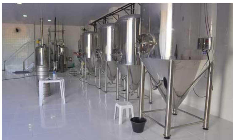
Figura 35 – Equipamentos (tanque fermentador e maturador) utilizados na empresa Cervejaria Boa Vista, Boa Vista, Brasil.
