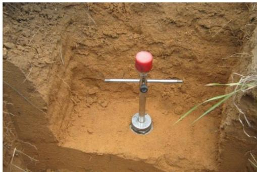
**Figura 4** - Retirada de amostras indeformadas de solo.
