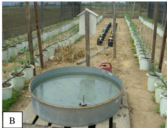
Figura 1: Casa de Vegetação utilizada no experimento (A). Tanque Classe A e abrigo meteorológico (B). Solo peneirado e sendo corrigido com calcário sobre lona plástica (C e D). Instalação do sistema de irrigação por gotejamento (E e F). Boa Vista – RR.
