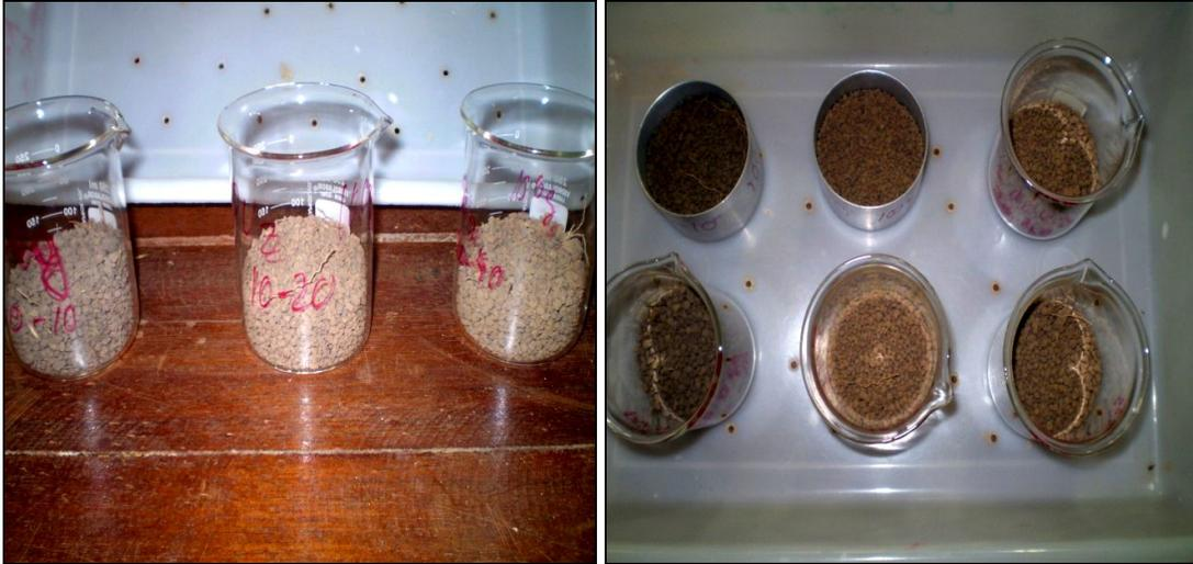
Fotos 17 e 18 – Detalhes das classes de agregados, após sua separação e secagem.
