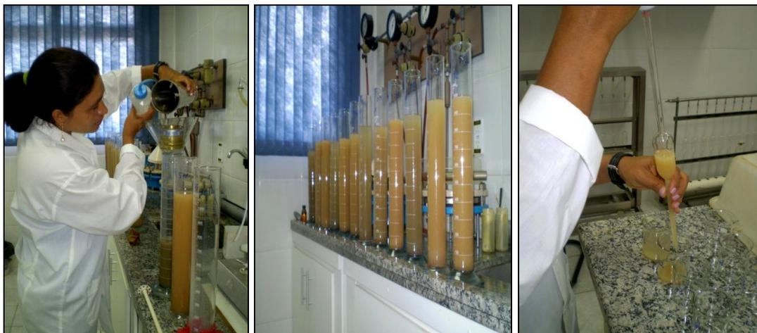
Fotos 14, 15 e 16 – Detalhes dos trabalhos de laboratório, mostrando a determinação da Argila Dispersa em Água (AD).
