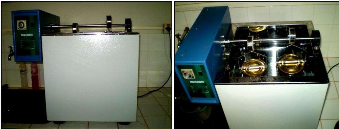
Fotos 19 e 20 – Detalhes do equipamento utilizados na determinação das classes de agregados via úmida.
