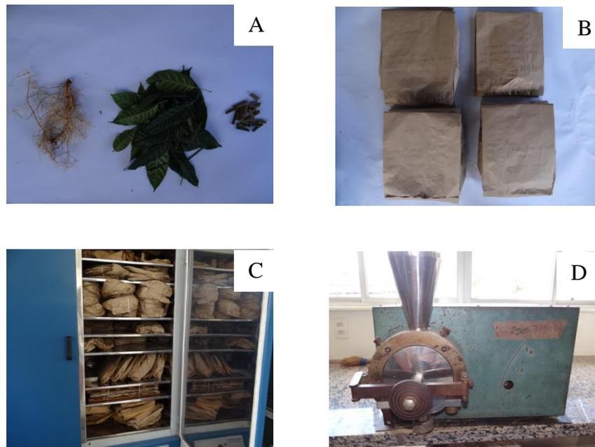
Separação das partes: raiz, folhas e caule para determinação da matéria seca (A); Acondicionamento em sacos de papel (B); Estufa de secagem (C); Moinho (D).
