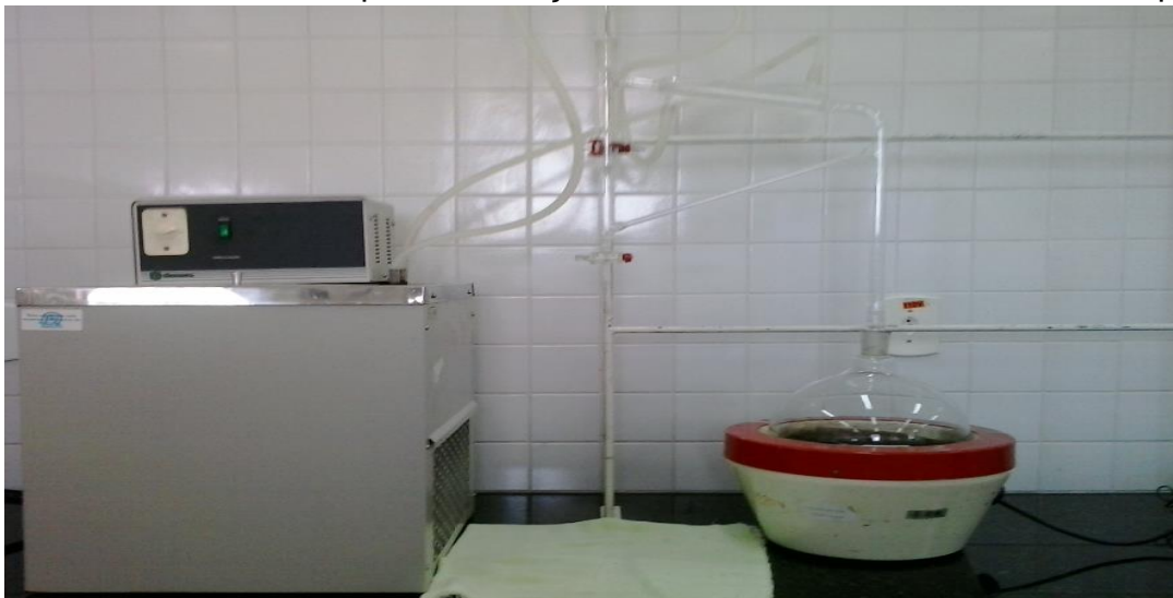
Figura 7 – Sistema utilizado para a extração do Óleo essencial de Aristolochia sp
