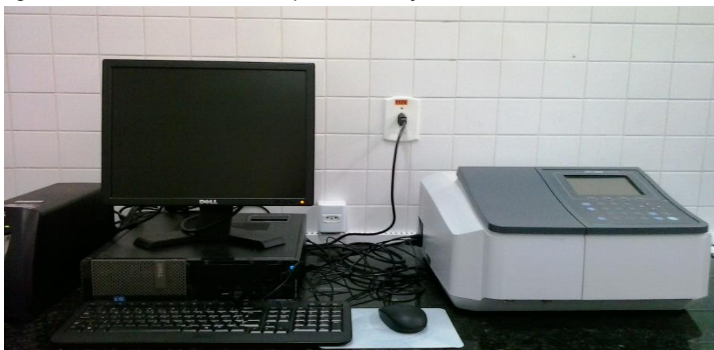
Figura 9 – Sistema UV-visível para realização da Atividade Antioxidante
