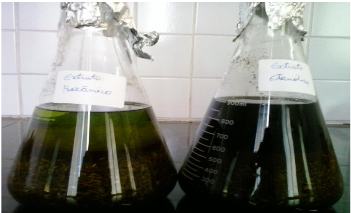
Figura 8 – Erlenmeyers com as amostras contendo os solventes Hexano e Etanol para a obtenção dos extratos
