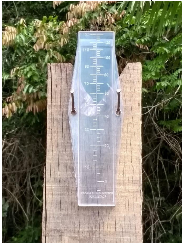
Figura 4 – Pluviômetro instalado no PARNA Viruá para a coleta de dados.
