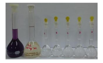
Os testes foram realizados em tubos de ensaio com uma mistura de 3,5 mL de solução padrão de mel e 1,5 mL de DPPH para elaboração da solução de reação da amostra. As absorbâncias de cada ponto, em triplicata, foram lidas a 515 nm após 30 minutos da reação e incubação no escuro. O branco foi constituído de 3,5 mL da solução padrão (mel) acrescido de 1,5 mL de metanol e o controle positivo com 1,5 mL de solução de DPPH e 3,5 mL de
