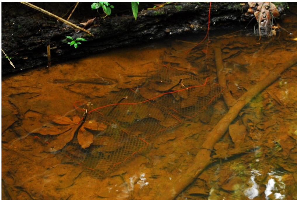
Figura 9 – Litterbags fixados sobre o leito do igarapé por 30 dias ( \pm 2 ), na Serra Bonita, Cantá, Roraima.
