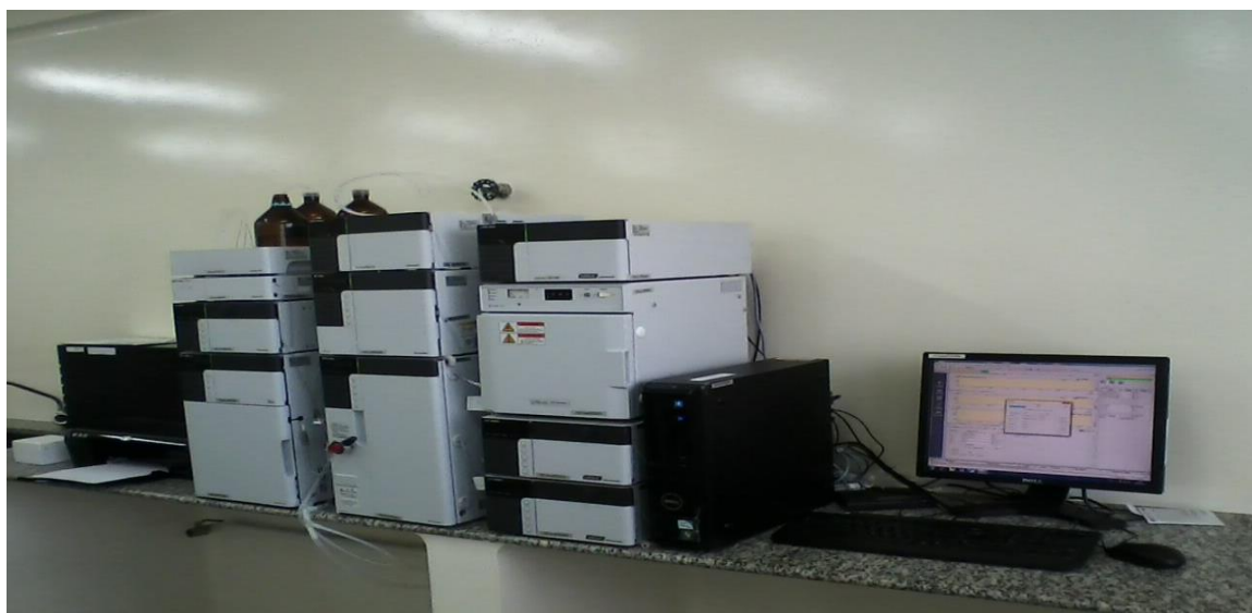
Figura 11 – Cromatógrafo a líquido utilizado nas pesquisas - PRONAT/ UFRR.
