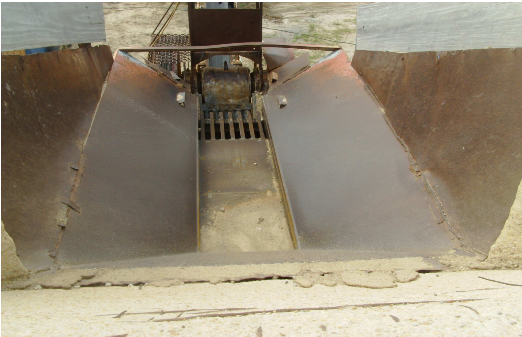
Figura 26 - Alimentador vibratório, para o processo de britagem, Distrito Industrial, Caracaráí – RR.
