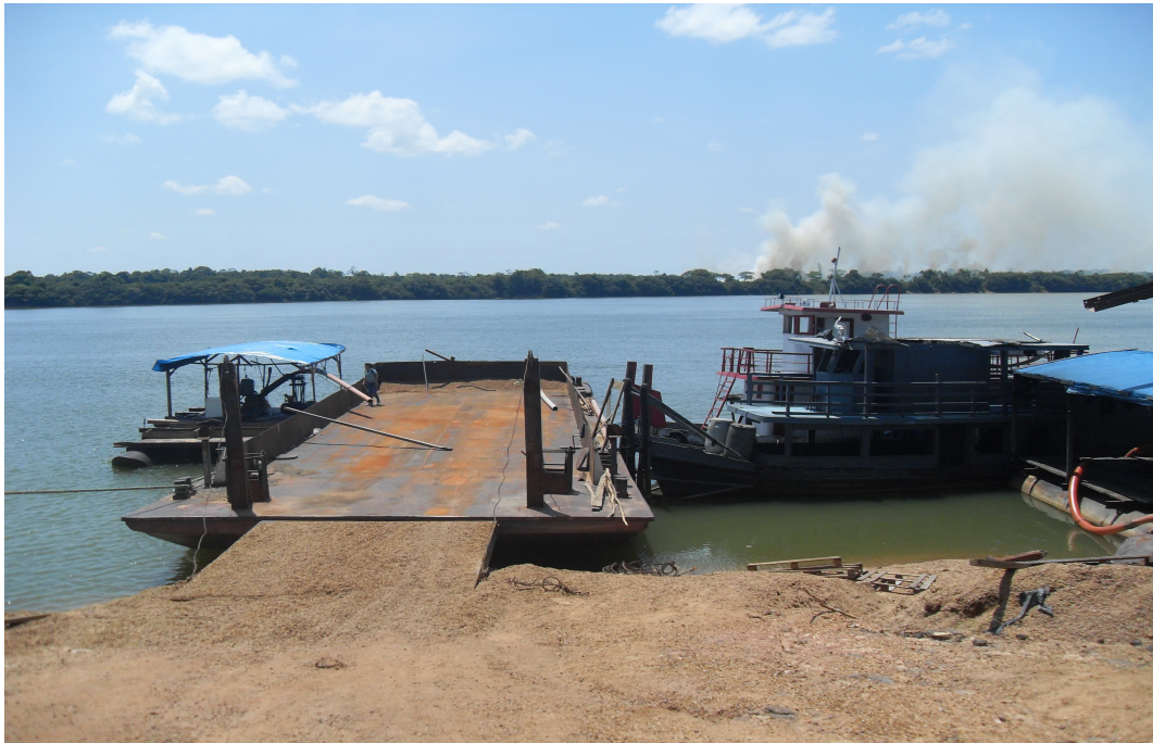
Figura 19 – Balsa acoplada a uma draga que sustenta as bombas de sucção e armazena a areia ou seixo, quando retirados do rio. Caracaraí – RR.
