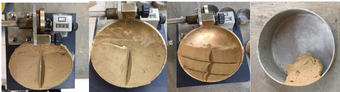
Figura 5 - Execução do ensaio de limite de liquidez no aparelho de Casa Grande.
