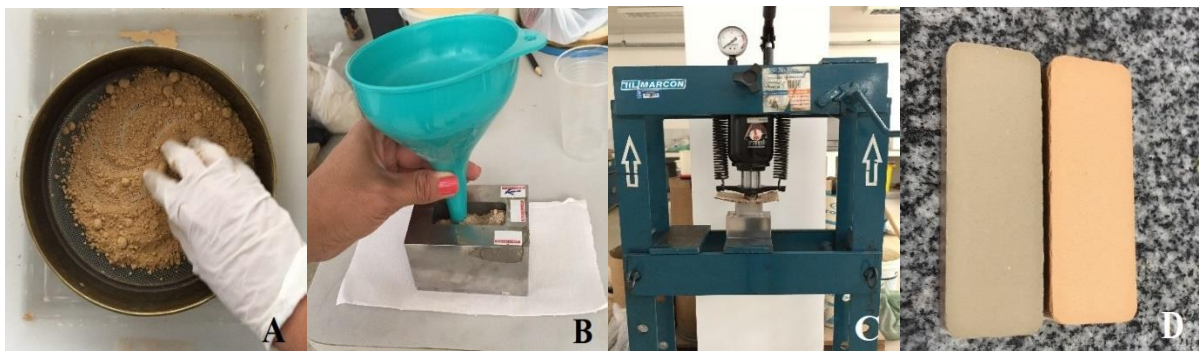
Figura 11 - Etapas da confecção de corpo de prova cerâmico: peneiramento da massa (a), posicionamento da massa na matriz (b), prensagem do CP (c) e CP confeccionado (d).
