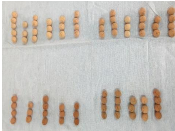
Figura 8 - Esferas após calcinação em forno tipo Mufla: determinação da perda ao fogo.
