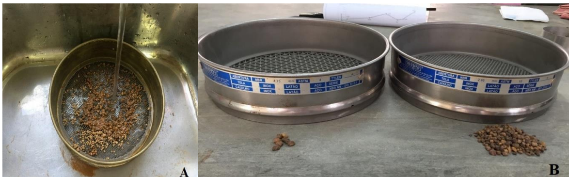
Figura 3 - Lavagem do solo submetido à análise granulométrica (a) e grãos provenientes do peneiramento grosso (b).
