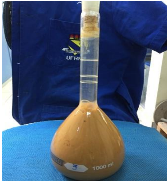
Figura 7 - Execução do ensaio de massa específica, retirada de vácuo do volume do balão.
