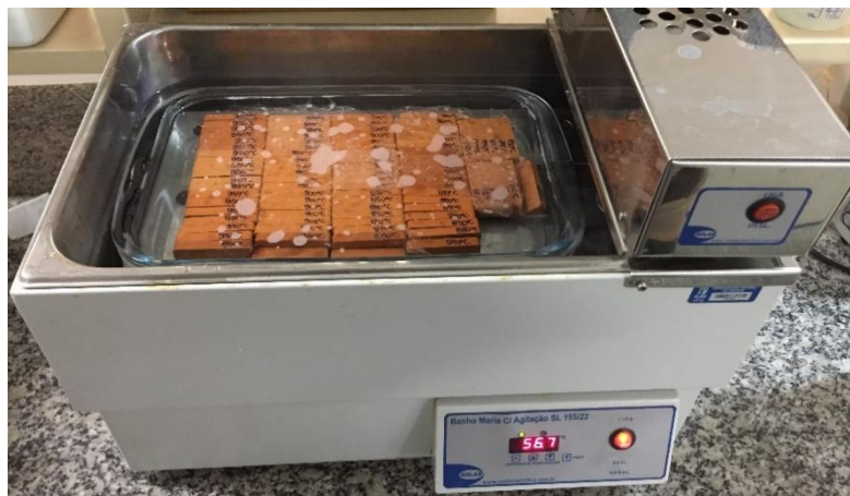
Figura 14 - Execução do ensaio de absorção de água com imersão dos corpos de prova em banho Maria com temperatura de aquecimento de 100°C.
