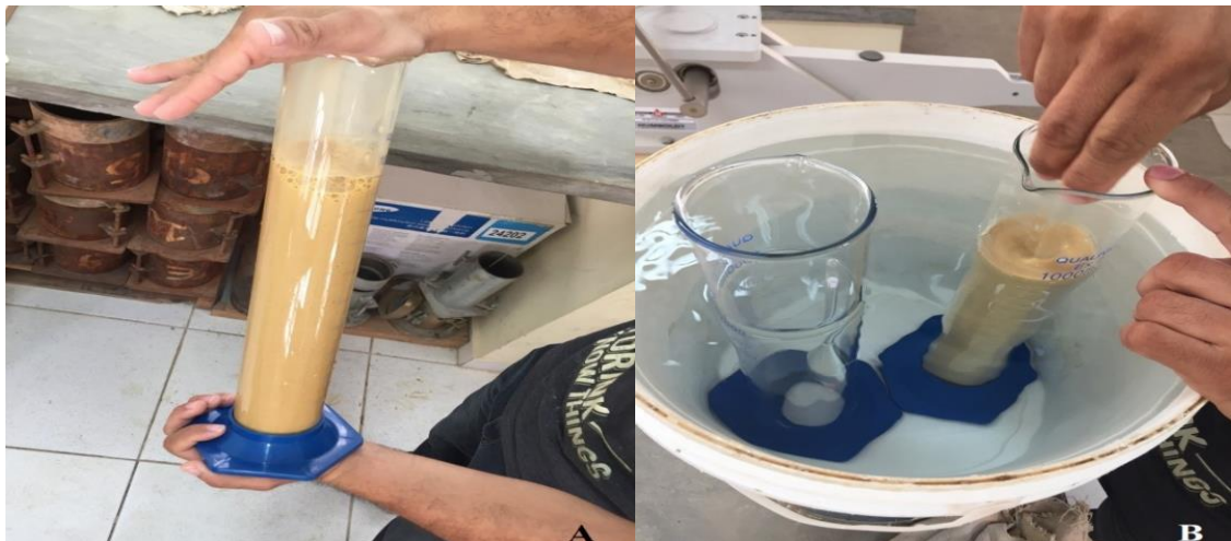
Figura 4 - Realização da etapa de sedimentação da análise granulométrica: agitação manual da proveta (a) e repouso do material em um recipiente com água (b).
