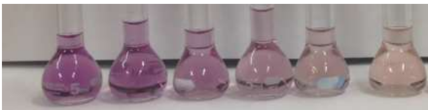
Figura 8 - Detalhe do descoramento da solução de DPPH (0,06 mM) a partir de alíquotas crescentes de Trolox (5 \mu M) para construção da curva de calibração. Na sequência da esquerda para direita, alíquotas 5 \mu L, 35 \mu L, 70 \mu L, 105 \mu L e 140 \mu L.
