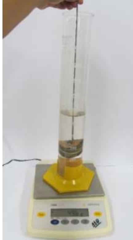
Figura 10 - Medição do peso da água deslocada
