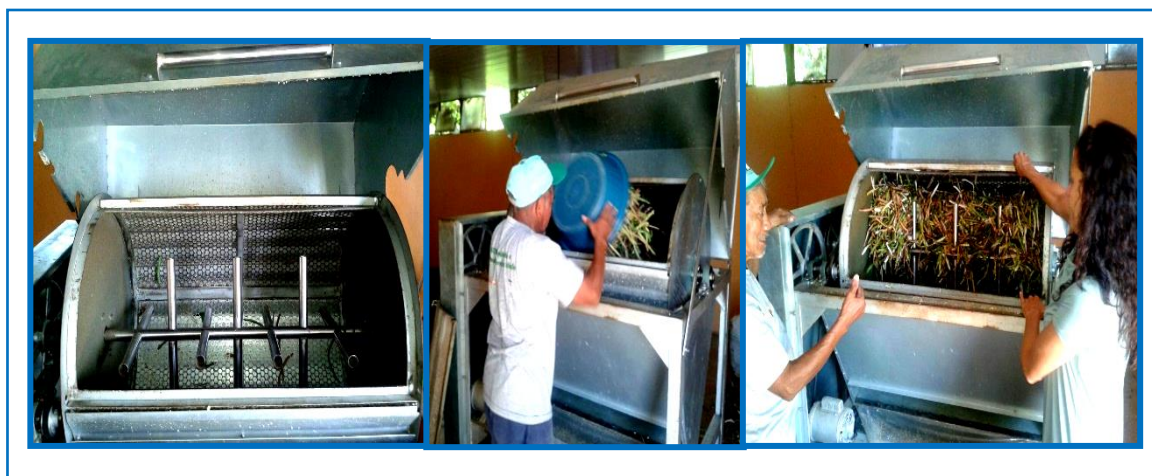
Foto 6 - Registro fotográfico da Máquina de debulhar feijão verde
